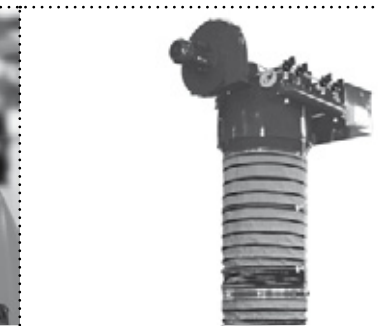
VERLADE- GARNITUREN SILOFAHRZEUGBELADUNG
